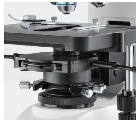
OBN-15: Condensatore a contrasto di fase montato
