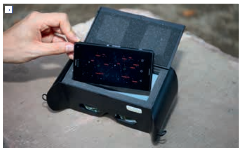
Abb. 2: Die Brille des Universe2go besteht aus einem Gehäuse, in dem sich ein Spiegel befindet. Wird das Smartphone an der dafür vorgesehene Position eingelegt, wird dessen Anzeige in das Blickfeld eingespiegelt. Stefan Fiebiger
