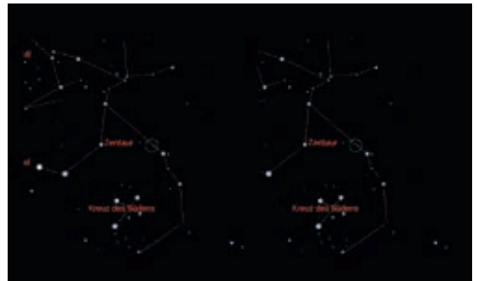
▲ Abb. 5: Mit Beobachtungsbrille wird der Bildschirm in geteilter Sicht dargestellt. Beim Einlegen in die Brille wird daraus aber durch die Optik ein Bild. So können Korrekturen für den Augenabstand oder der Ausgleich eines schwächeren Auges umgesetzt werden.
