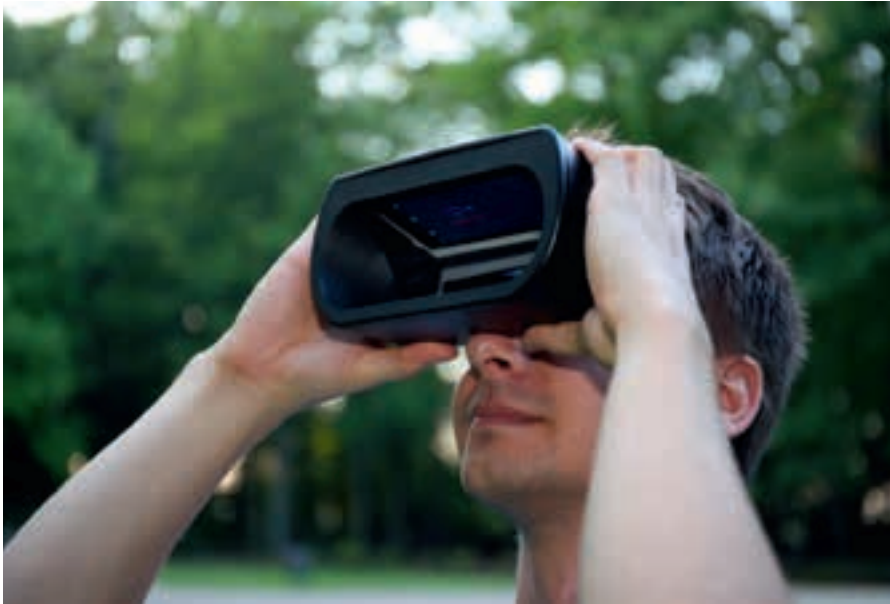
▲ Abb. 3: Der Beobachter nimmt die Brille mit dem darin befindlichen Smartphone in die Hand und blickt durch sie hindurch. Durch das geringe Gewicht von 175g (zzgl. Gewicht des Telefons) ist auch eine längere Beobachtung möglich. Stefan Fiebiger
